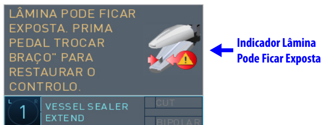
Figura 3.1 Mensagem Lâmina Pode Ficar Exposta. Pressione o pedal de troca de braço.
