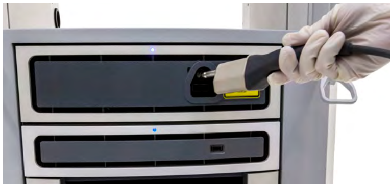
Figura 7.7 Conecte o conector ao Controlador do Endoscópio
