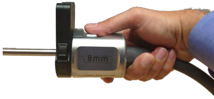
Figura 7.11 Endoscópio na orientação para baixo
