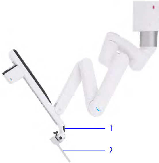
Figura 9.21 Exemplo de onde apoiar o braço para ajustar a articulação flexível
