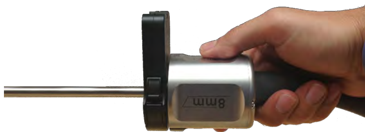
Figura 7.12 Endoscópio na orientação para cima
