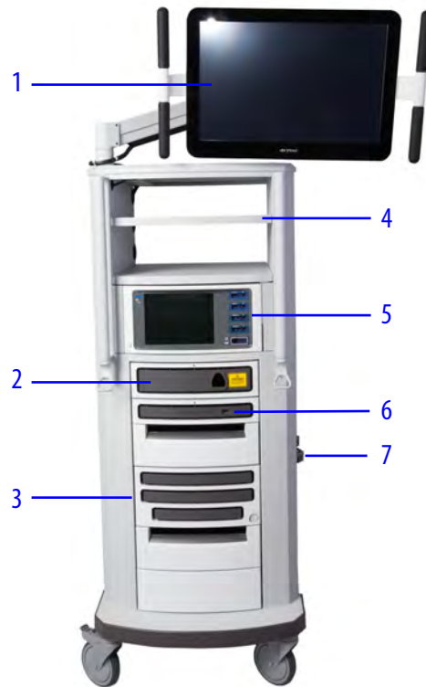
Figura 2.6 Principais componentes e equipamentos eletrônicos do Carrinho de Visão
