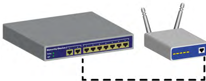
Figura A.5 Dispositivo de Segurança de Rede com Ponte Sem Fio
