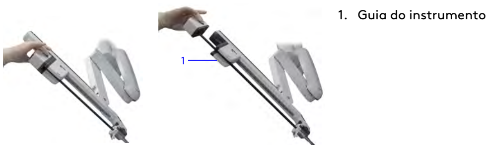
Figura 9.28 Barreira de esterilização (e exemplo de rompimento de barreira de esterilização)
