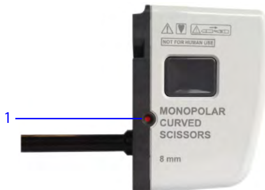
Figura 9.30 Indicador do número máximo de utilizações em um instrumento expirado
