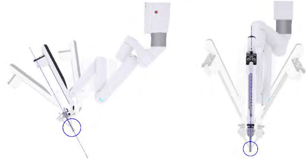
Figura 9.16 Exemplos de movimento da embreagem do instrumento
