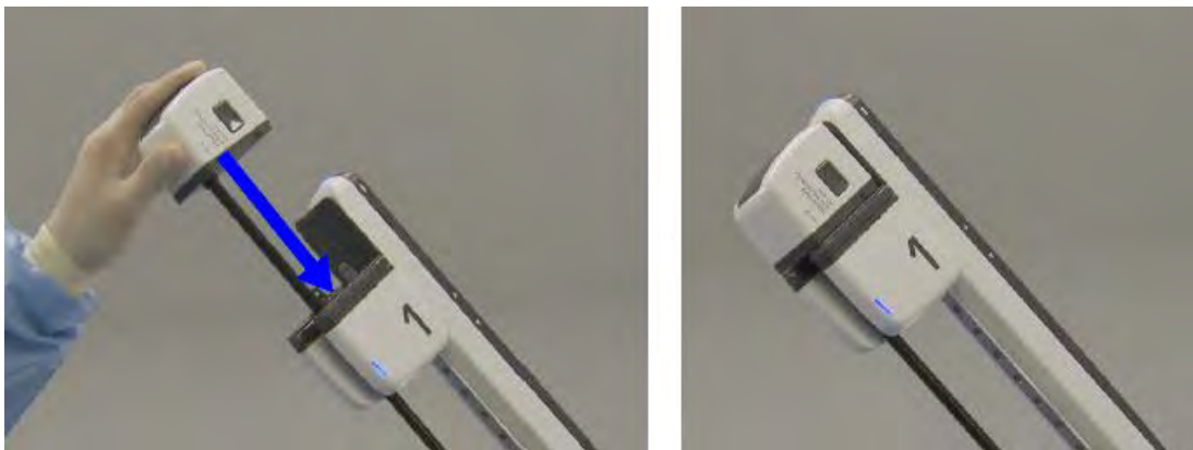
Figura 9.25 Introdução do instrumento dentro da cânula e do adaptador estéril
