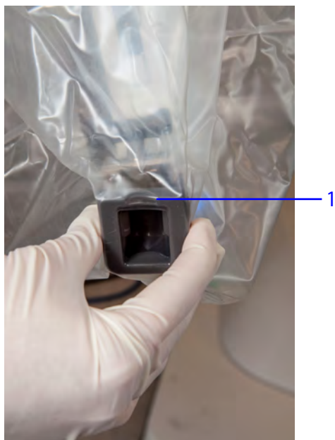
Figura 6.9 Conecte o adaptador estéril da cânula
