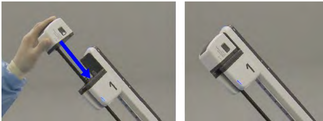
Figura 9.18 Introdução do instrumento dentro da cânula e do adaptador estéril
