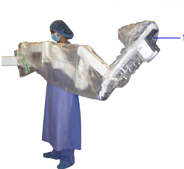
Figura 6.14 Instalação do Campo Cirúrgico do braço principal
