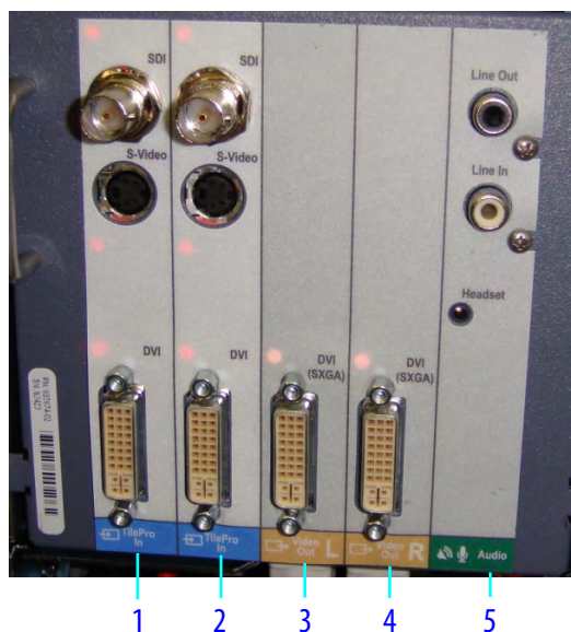
Figura F.2 Conexões na parte traseira do Console do Cirurgião
