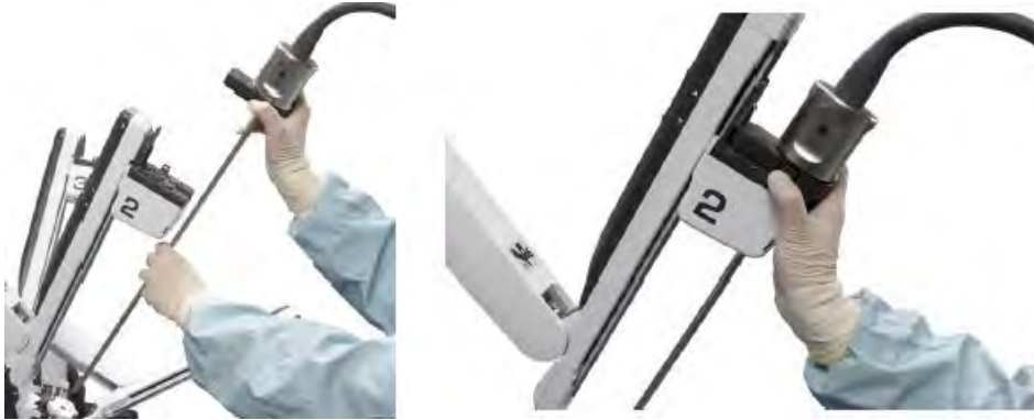
Figura 7.17 Introdução do endoscópio dentro da cânula e do adaptador estéril
