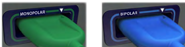
Figura 6.15 Conectores nas portas corretas
