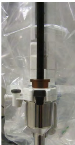
Figura 2.10 Deslizar o introdutor do instrumento eixo abaixo antes da remoção do instrumento
