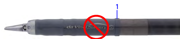
Figura 7.4 Cobertura da Tampa instalada além da posição correta
