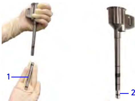
Figura 11.9 Exemplos de aprovação e reprovação com o pino calibrador
