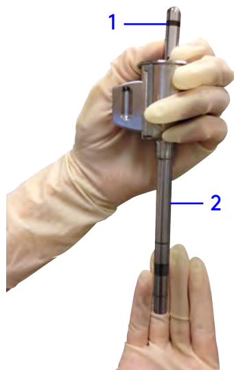
Figura 11.9 Exemplos de aprovação e reprovação com o pino calibrador
