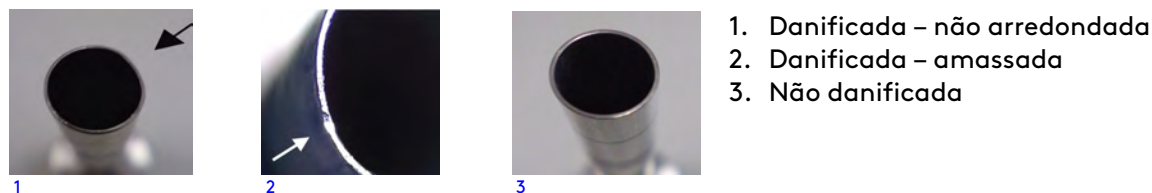
Figura 11.5 Exemplos de inspeção visual
