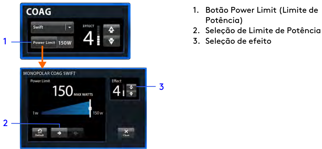
Figura 6.12 Configurações de limite de potência, exemplo de COAG monopolar
