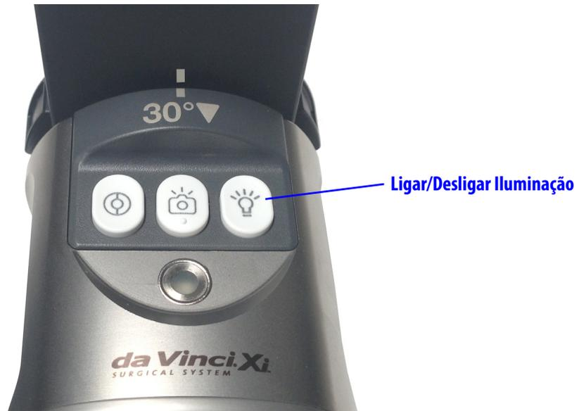
**Figura 3.8 Botão Iluminação LIGADO/DESLIGADO (exemplo)**
