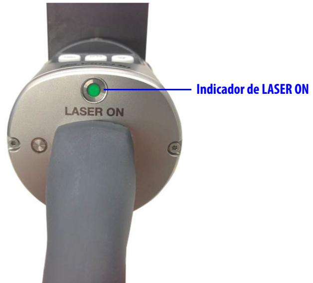
**Figura 2.6** Indicador de LASER ON
