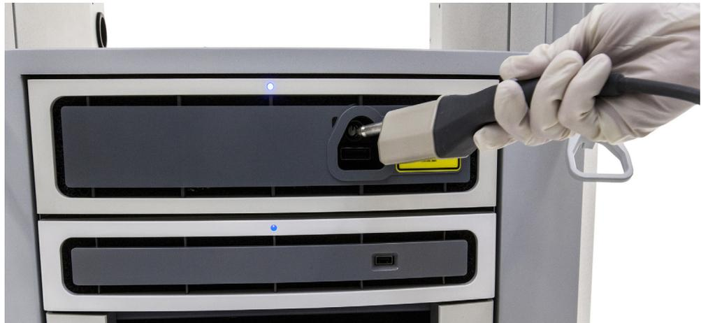
**Figura 3.1** Conecte o conector ao Controlador do Endoscópio
