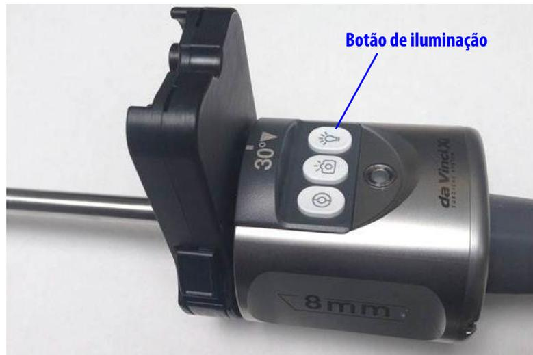
**Figura A.1** Botão de iluminação do endoscópio (exemplo)
