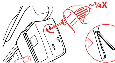
Figura 3.16 Insira no orifício de acesso 3 e gire \frac{1}{4} no sentido horário
