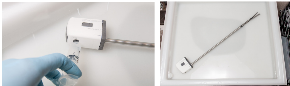
Figura 2.27 Preparação e imersão dos instrumentos
