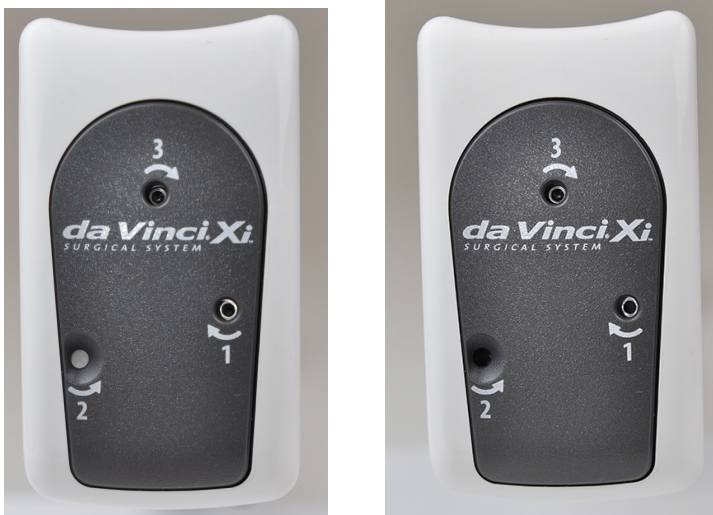
Figura 3.14 Orifício de liberação 2 com o ponto branco (esquerda) e sem o ponto branco (direita)
