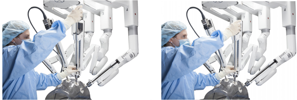
Figura 2.7 Introdução do instrumento dentro da cânula e do adaptador esterilizado
