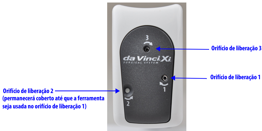
Figura 3.11 Orifícios de acesso para liberação do grampeador
