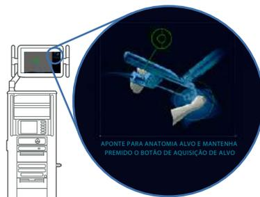
Durante a definição do alvo, a lança do Carrinho do Paciente será alinhada com a porta inicial do endoscópio, girará para orientar os braços do instrumento em direção da anatomia-alvo e ajustará a altura para evitar contaminação. A definição do alvo também ajuda a evitar os limites de amplitude de movimento do Carrinho do Paciente que poderiam impedir o movimento da mesa em toda a extensão durante o procedimento.
