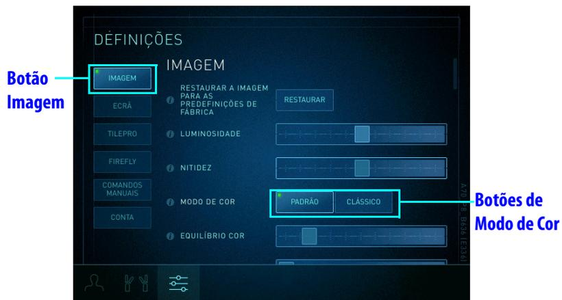
**Figura 3** Para alguns endoscópios, o modo de cor pode ser alternado entre Padrão e Clássico no touchpad
